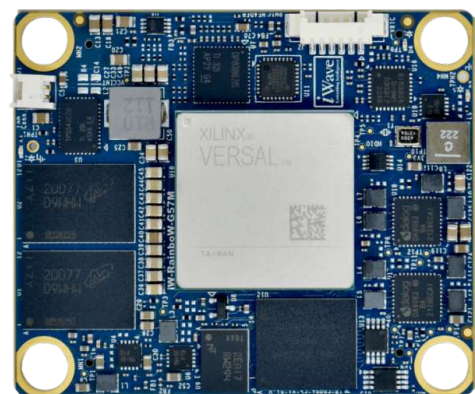
Versal FPGA SoM fitting GenAI NPU 1x (actual size)
